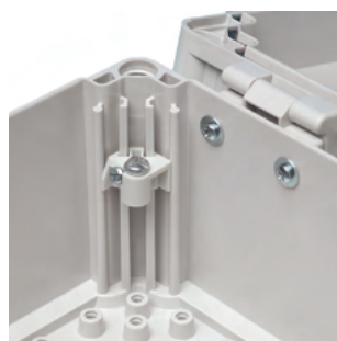
V krabicích Ensto Cubo O, C a W je nastavitelný rohový jezdec, který umožňuje montáž desek a panelů v libovolné výšce
